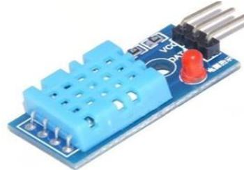
**Figure 2. DHT11 Sensor**
